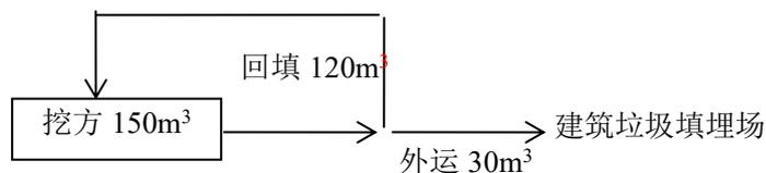
图 4: 土石方平衡图
