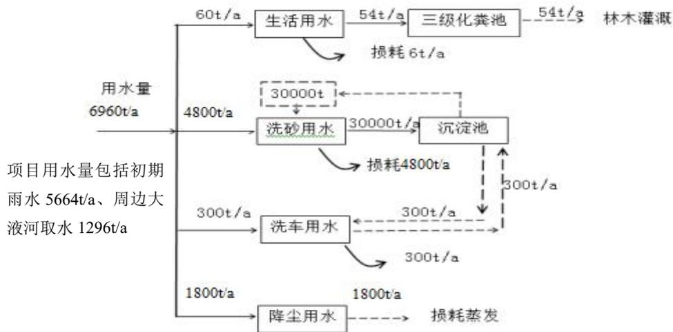
图 5：项目水平衡图（单位：t/a）
