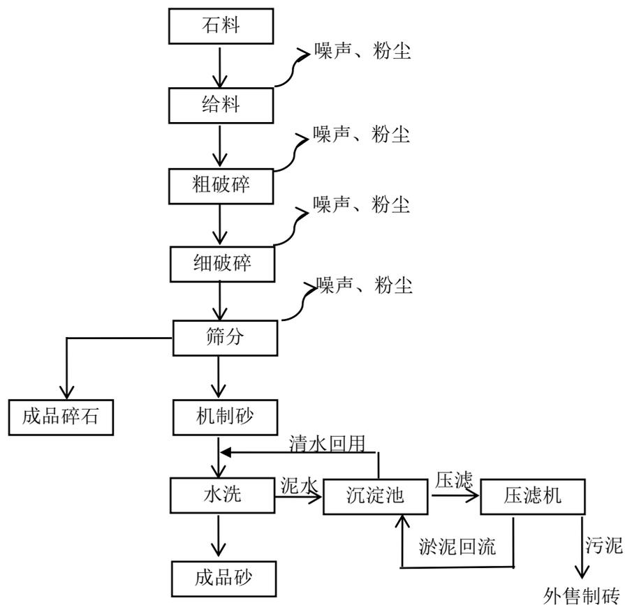
图3：项目生产工艺流程及产污环节示意图
