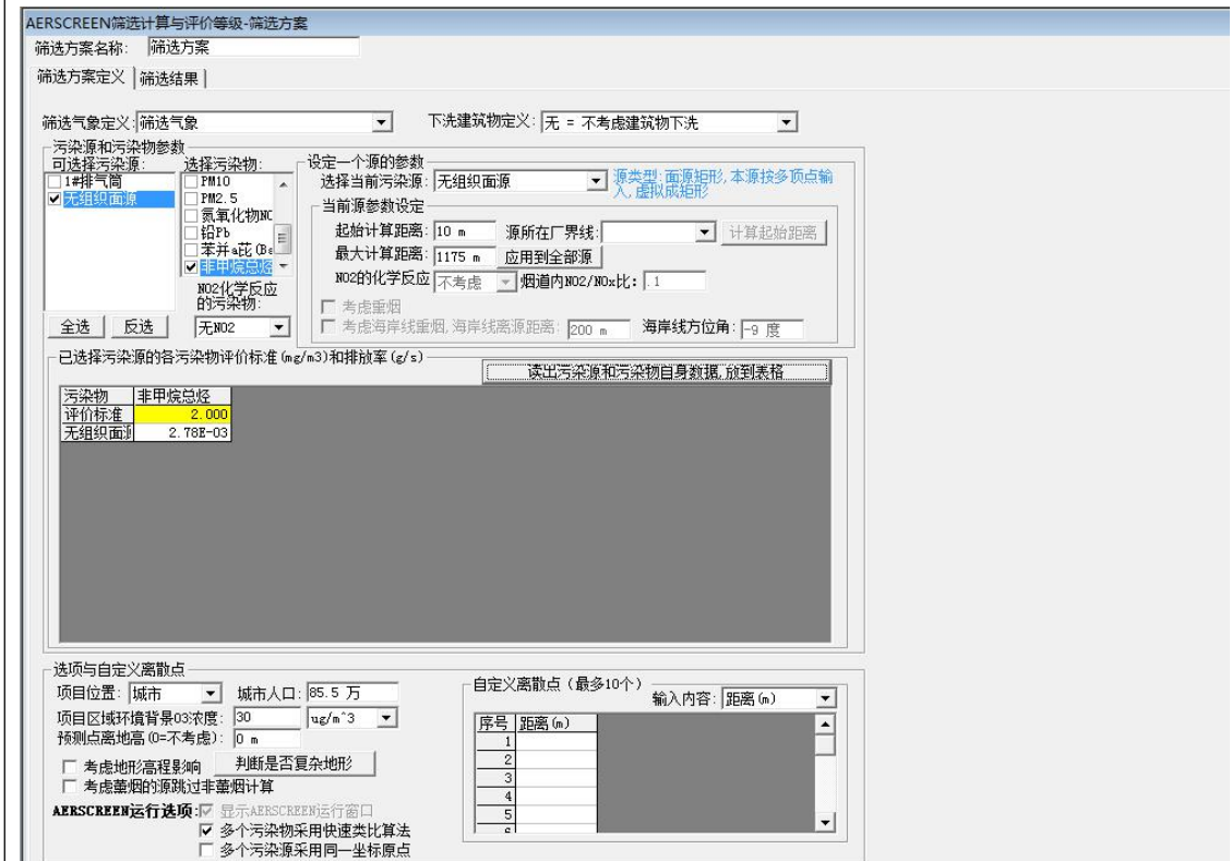
图4 有组织排放非甲烷总烃下风向最大质量浓度占标率预测结果截图
