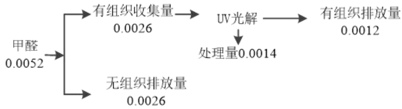
图 2-5 现有工程甲醛平衡示意图
